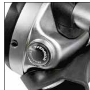
Botón de desactivación manual
